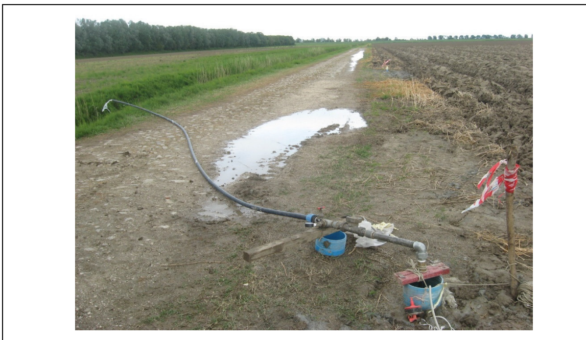
Figura. 9.1. Configurazione impiantistica per la prova di portata.
