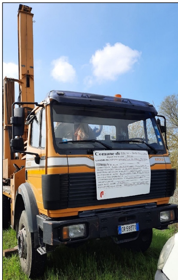
Figura 3.2. Perforatrice idraulica COMETRIA utilizzata.
