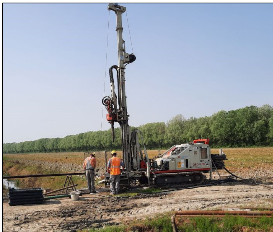
Figura 3.1. Perforatrice idraulica COMACCHIO GEO 601 utilizzata.
