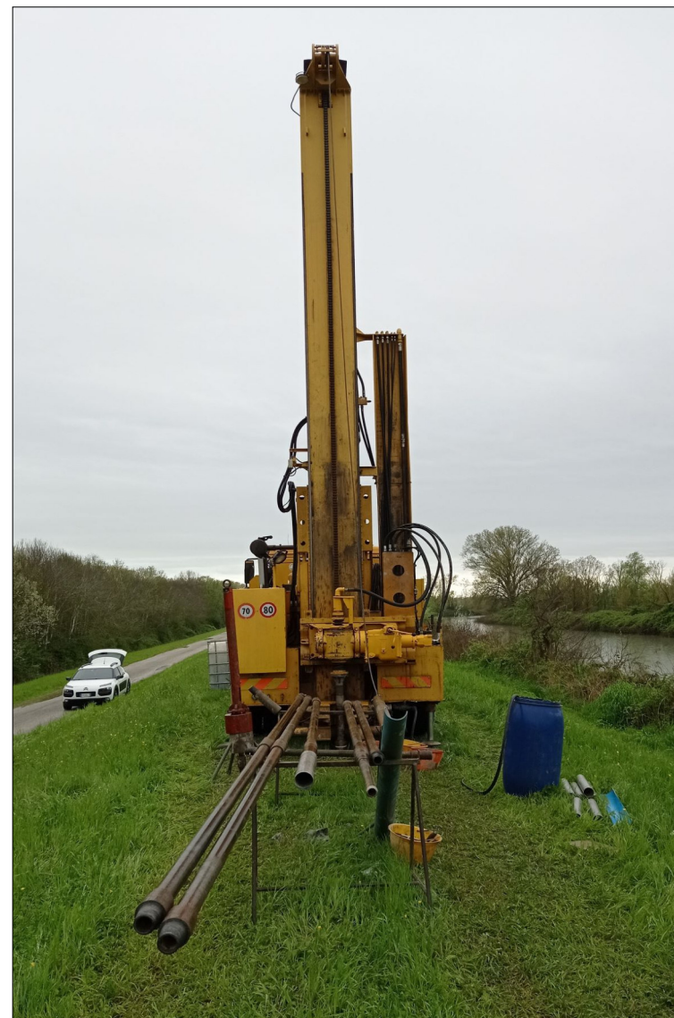
Piazzamento perforatrice su punto di sondaggio S4-2023
