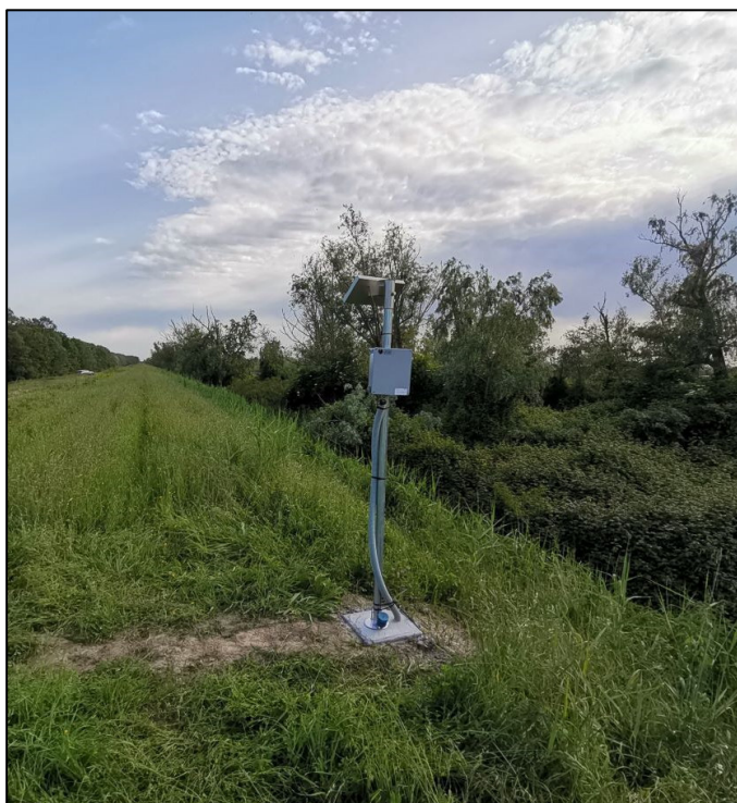
Figura 8.2. Sistema di monitoraggio piezometrico automatizzato.
